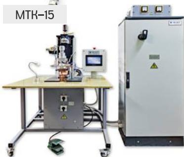
Машины предназначены для точечной сварки изделий из нержавеющих, жаропрочных, низколегированных сталей, титановых и цветных сплавов.
