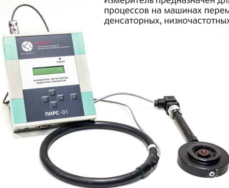
Измеритель предназначен для измерения основных параметров сварочных процессов на машинах переменного тока, машинах с выпрямлением, конденсаторных, низкочастотных и инверторных машинах.
